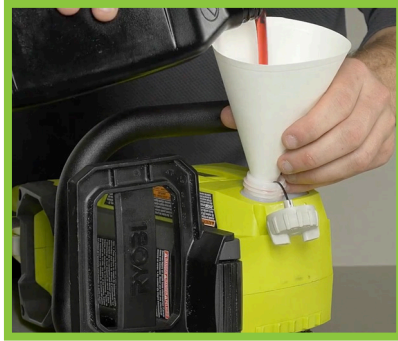
Có phễu và lót mùn cưa trên lớp lót chống thấm tránh rót dầu khi đổ dầu cho cưa xăng
